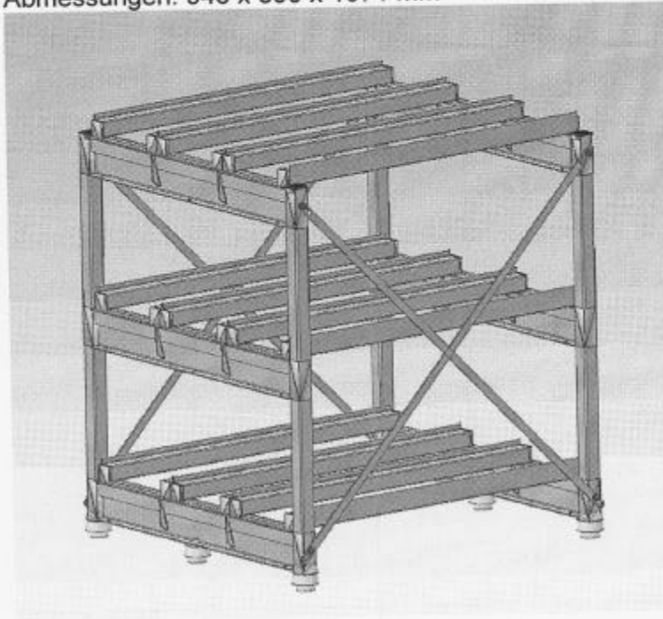
Classic-Gestell, Typ-Nr.: 36200010113B Abmessungen: 946 x 890 x 1071 mm
